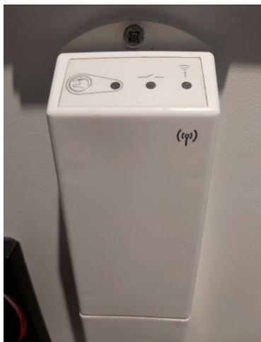
Pour activer le mode initialisation sur le récepteur, rester appuyé sur le bouton manuel
