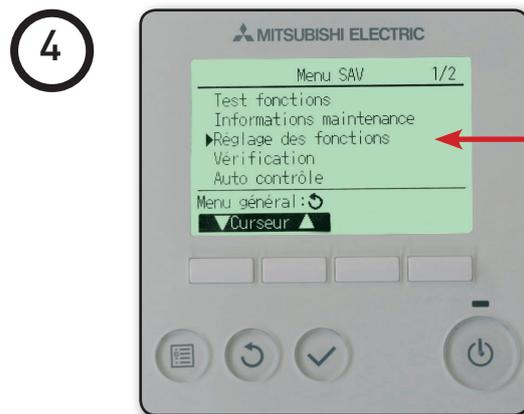
> Dans le «Menu SAV», aller sur «Réglage des fonctions» et valider.
